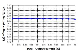
VIN=4.3V, VOUT=3.3V @ IOUT=100mA per 10mA step
