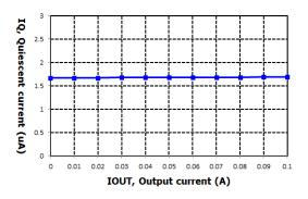
VIN=4.3V, VOUT=3.3V @ IOUT=100mA per 10mA step
