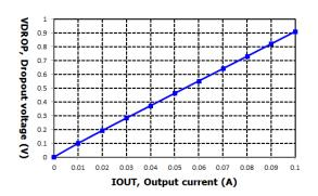
VIN=5.0V, VOUT=3.3V @ IOUT=100mA per 10mA step
