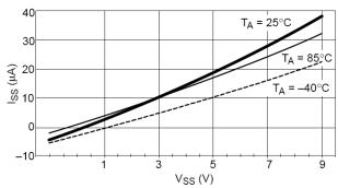
Figure 14. I<sub>SS</sub> vs V<sub>SS</sub>
